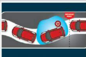
ABS+EBD+BA Menghindari terkuncinya roda saat pengereman mendadak sehingga pengemudi tetap dapat mengendalikan arah laju kendaraan.
